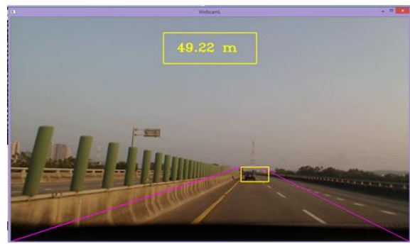
圖 71 汽車防撞警示雷達系統 1 秒後所拍攝到的影像(距離本車 49.22 公尺)
