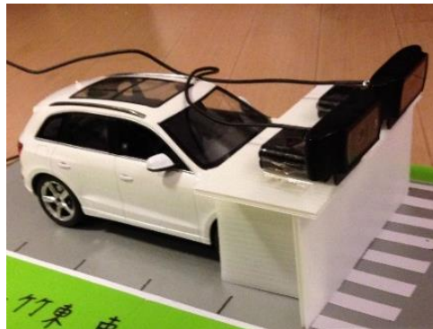
圖 69 本研究建立之汽車防撞警示雷達系統模型
