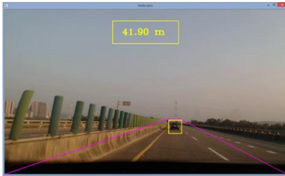
圖 70 汽車防撞警示雷達系統 1 秒前所拍攝到的影像(距離本車 41.90 公尺)
