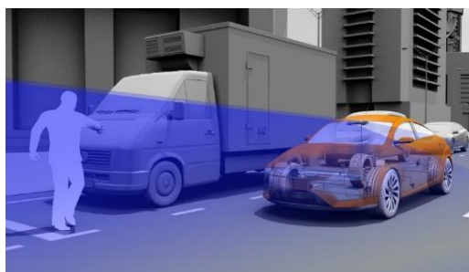
圖 29 先進駕駛協助系統實際運作情形〔16〕
