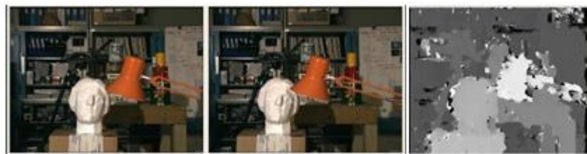
圖 20 立體匹配 BM 算法求深度圖〔10〕
